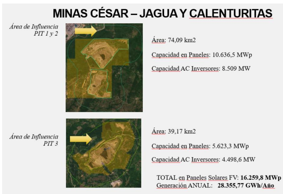
Gráfica 16: Potencial teórico de instalación de energía solar fotovoltaica en las áreas de los bloques 19 y 20 (descontando las áreas de los tajos). Fuente: elaboración propia
