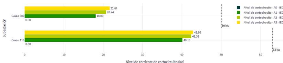
Figura 2-44. Capacidad de interrupción sugerida Subestación Corzo 500/115 kV Fuente: Elaboración UPME
