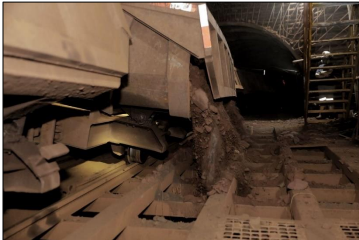
Figura 3. Paso de material del tren hacia la trituradora de mandíbulas
