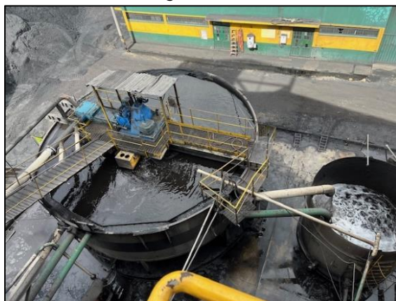
Figura 5. Tanque de recirculación de aguas – Procesos de floculación y neutralización.
