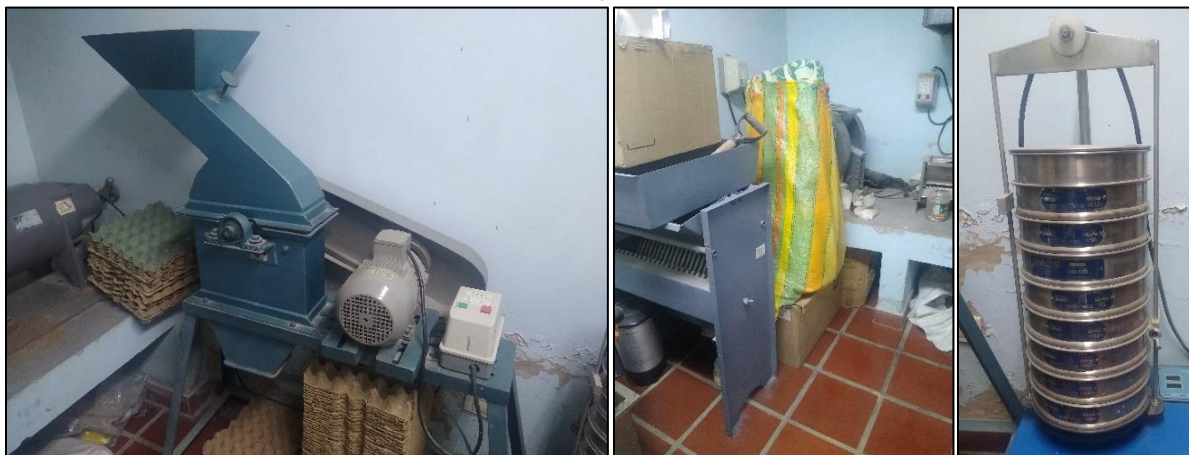
Figura 2. Trituradora, molino y juego de tamices observados en uno de los espacios de la unidad de diagnóstico
