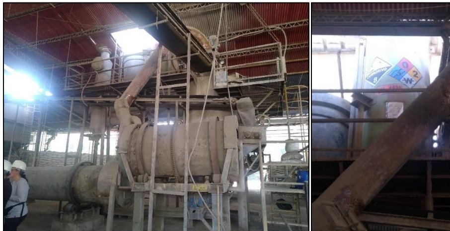
Figura 3. Sistema para acidulación del material y detalle del tanque de almacenamiento de químicos peligrosos
