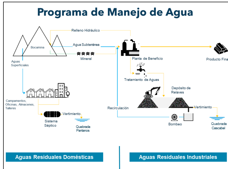
Figura 7. Procesos y tratamientos implementados dentro del programa de manejo de agua del PMA, para aguas residuales doméstica e industrial
