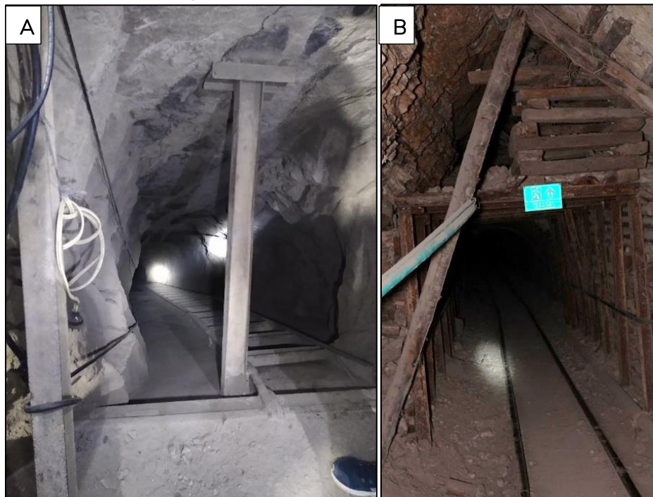
A. Tambor por donde descende el personal a los niveles inferiores en la mina. Nótese que el tambor se trabaja siguiendo el buzamiento de los mantos. B. Detalle del sostenimiento con vigas IPE dobladas y apoyo de cajoneras de relleno en madera. Fuente: UPME 2024
