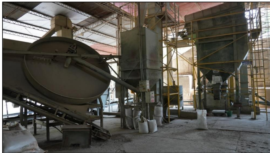
Figura 2. Granuladora de disco (izquierda) y sistema de tamizaje para empacar el material (derecha)
