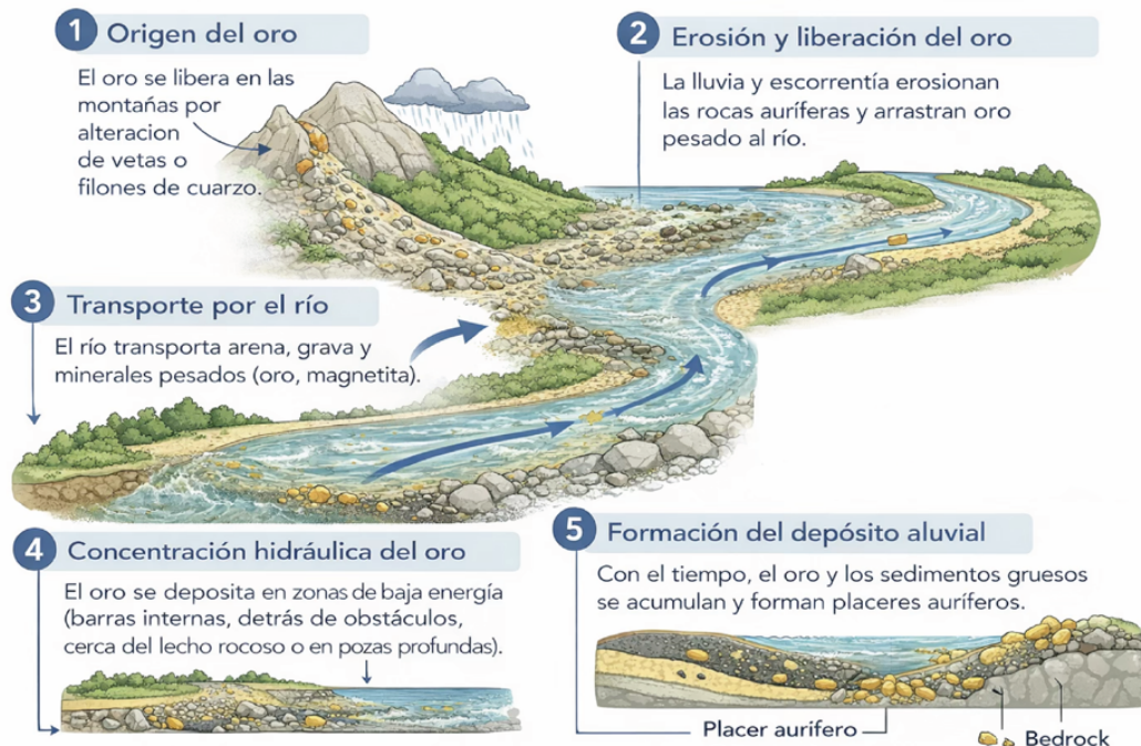
Figura 3.10. Formación de depósitos aluviales
