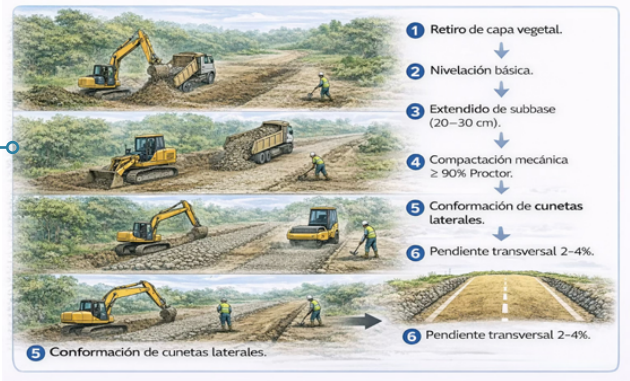
Figura 3.25. Cómo realizar la construcción de vías internas
