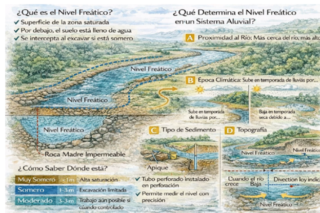
Figura 3.9. Explicación del nivel freático en minería de oro aluvial
