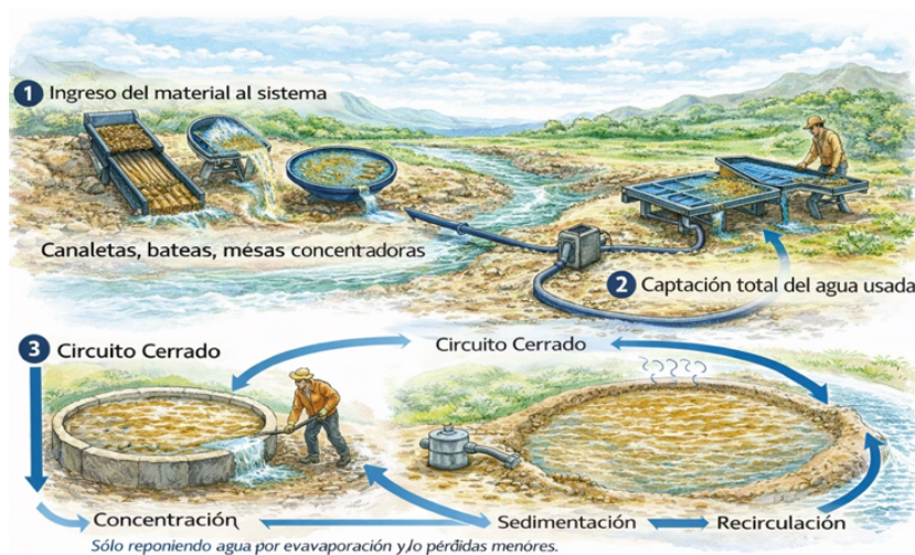
Figura 3.33. Concentración gravimétrica en circuito cerrado
