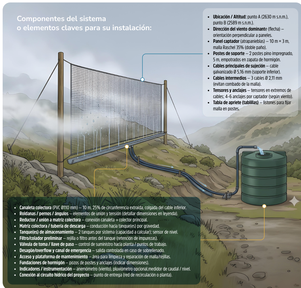
Figura 3.30. Componentes de un atrapaniebla
