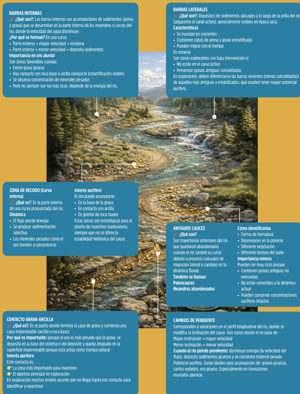
Figura 3.17. Elementos geomorfológicos y sedimentológicos del sistema fluvial con potencial aurífero
