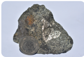
Pirrotina - Po (sulfuro de hierro deficiente en azufre) Fórmula: \text{Fe}(1-x)\text{S} Dureza: 3,5-4,5 Mohs Color: Bronce, marrón oscuro.
