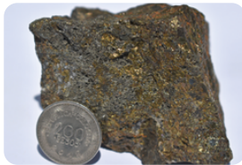
Calcopirita - Cp (mena de cobre) Fórmula: \text{CuFeS}_2 Dureza: 3,5-4 Mohs Color: amarillo latón.
