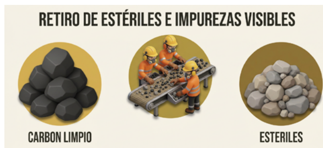
Figura 5-24 Retiro de estériles e impurezas visibles
