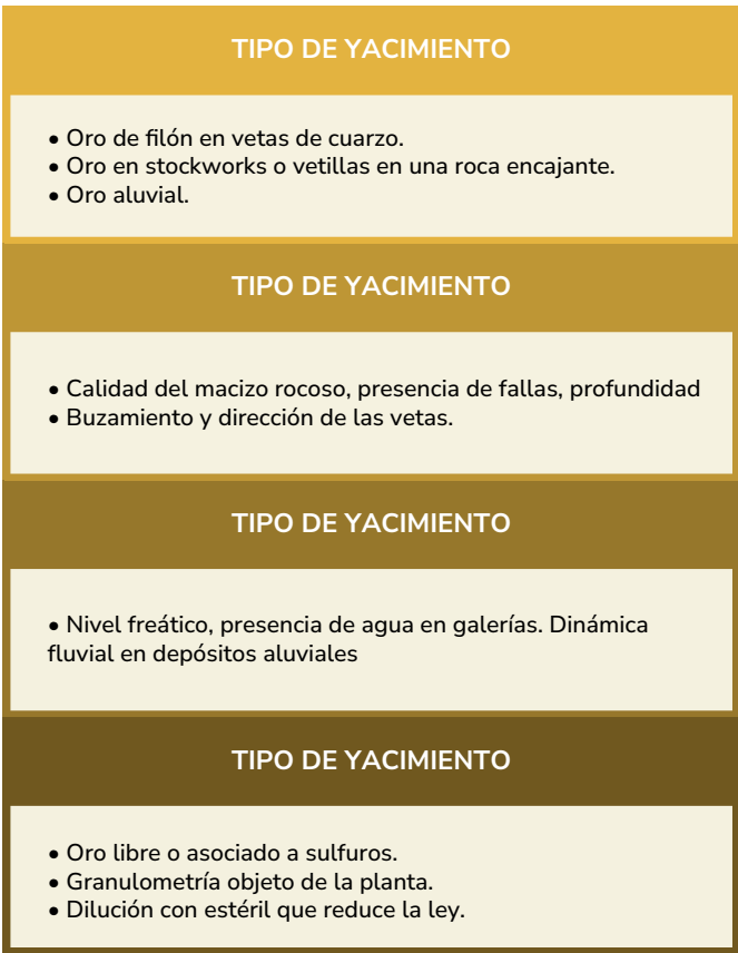
Figura 5-11 Condiciones para la selección de métodos de explotación
