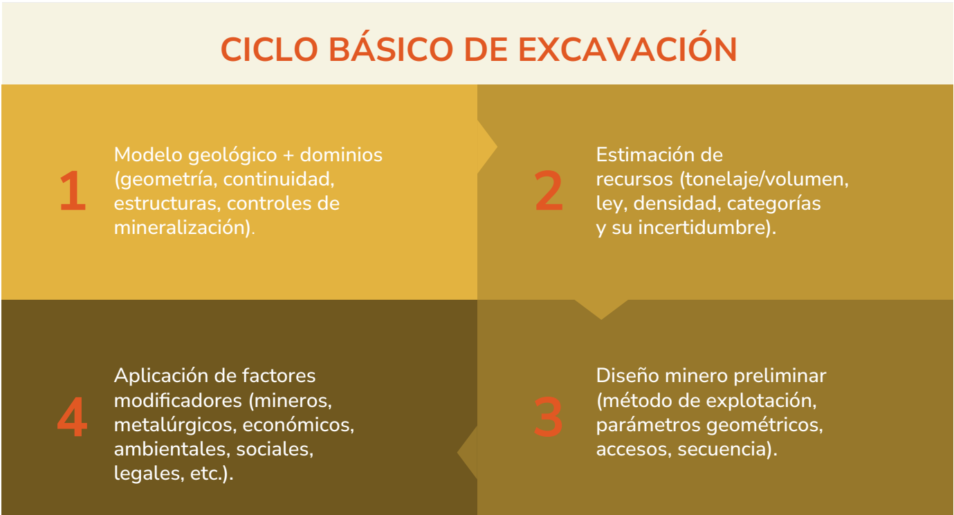
Figura 5-5 Ciclo básico de Excavación
