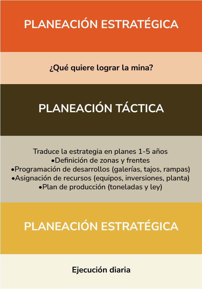
Figura 6-4 Lógica de planeación minera
