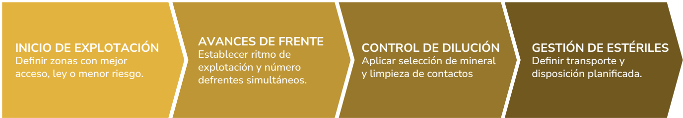
Figura 5-10 Lógica de explotación minera
