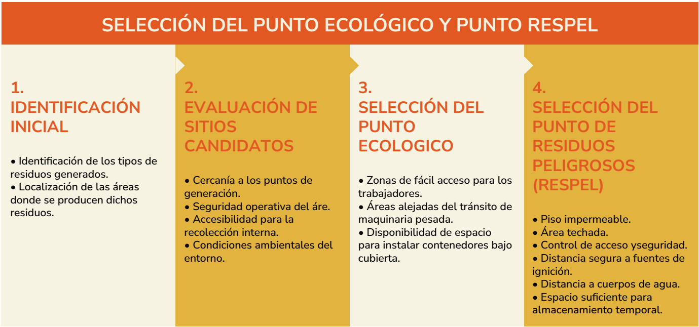
Figura 8-10 Ejemplo de clasificación de punto ecológico y área de almacenamiento temporal de RESPEL
