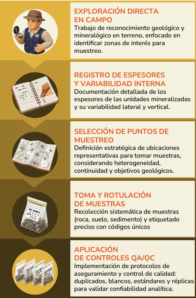
Figura 4-4 Proceso de exploración y muestreo (QA/QC)
