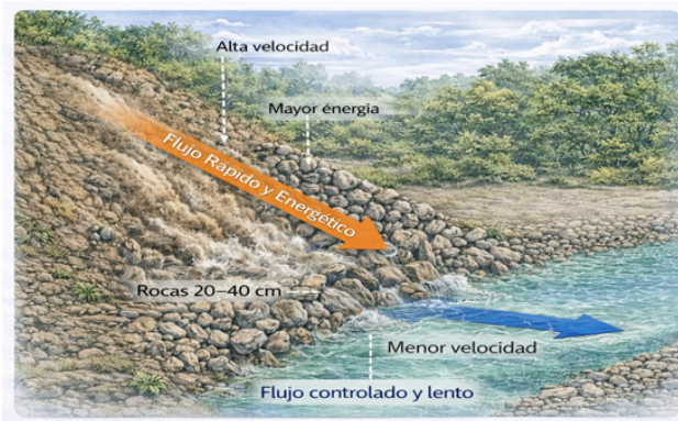
Figura 4.28. Tipos de disipadores en minería de oro aluvial
