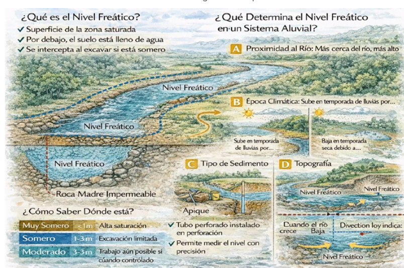
Figura 4.9. Explicación del nivel freático en minería
