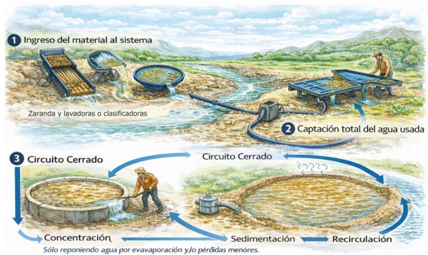
Figura 4.32. Concentración gravimétrica en circuito cerrado
