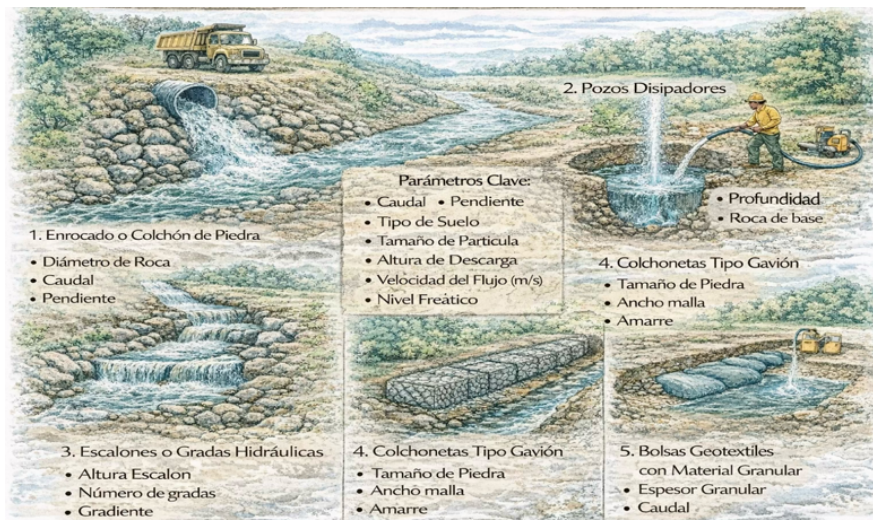
Figura 4.28. Tipos de disipadores en minería de oro aluvial
