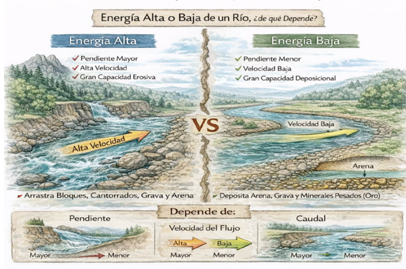
Figura 4.8. Interpretación de la energía del sistema fluvial
