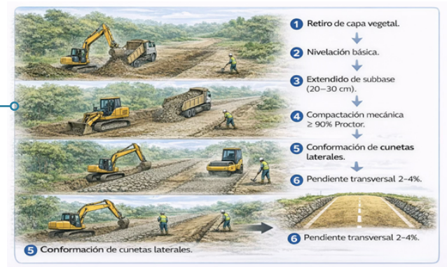
Figura 4.25. Cómo realizar la construcción de vías internas
