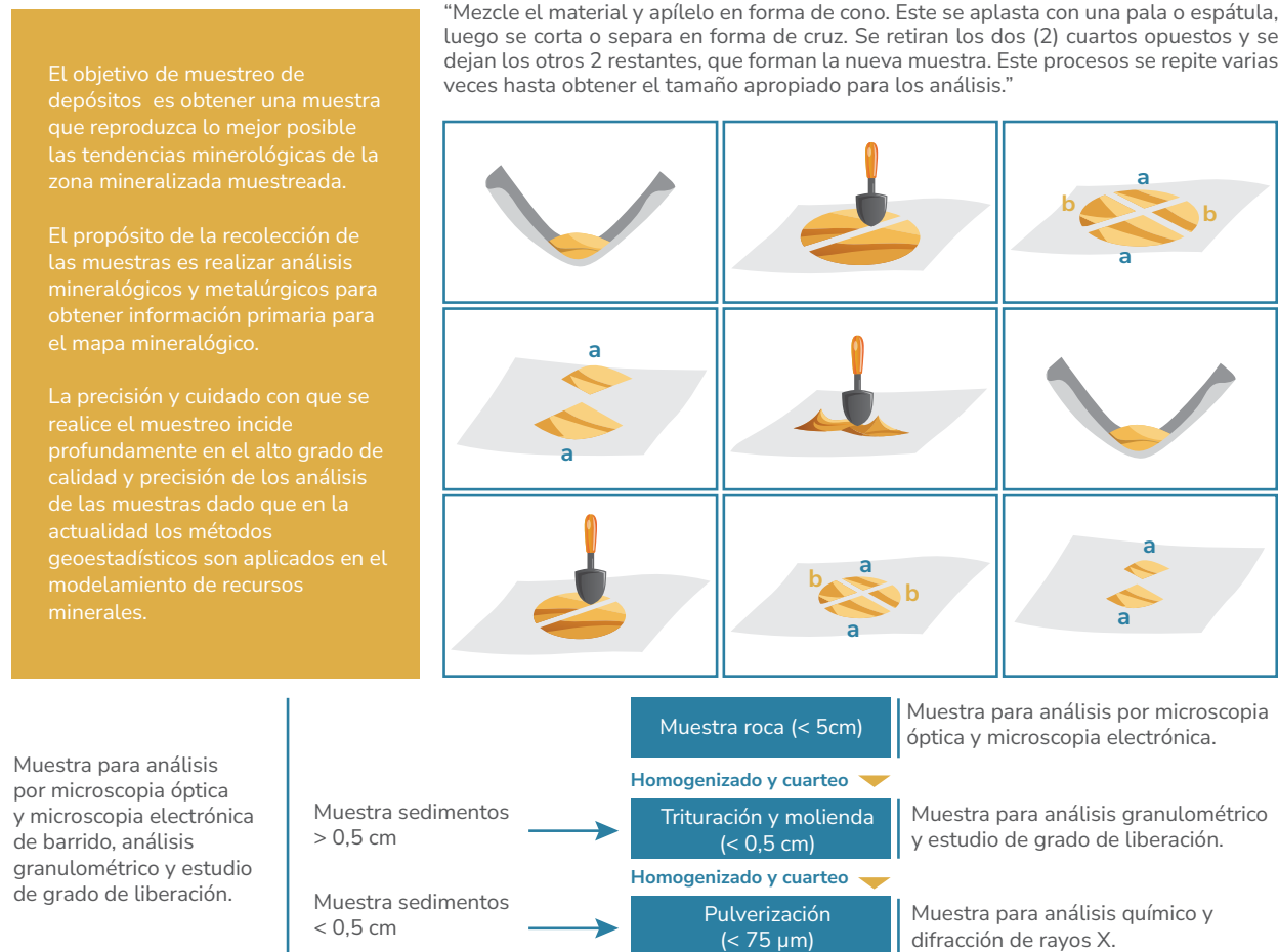
Figura 4.15. Procedimiento de muestreo y manejo selectivo del material
