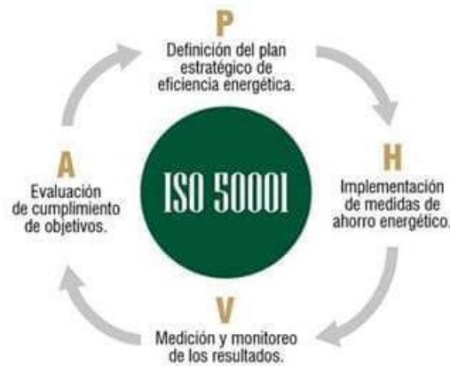
Figura 2. Esquema seguido por la ISO 50001
