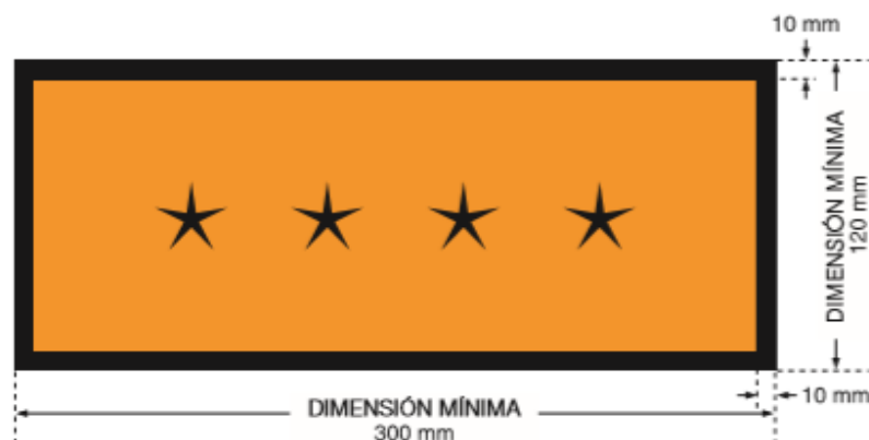
Figura 7: Rótulo para indicar por separado el número de las Naciones Unidas. El color de fondo del rótulo será naranja y los bordes y el número de las Naciones Unidas serán negros. El símbolo "****" indica el espacio en el que deberá insertarse el número de las Naciones Unidas apropiado para los materiales radiactivos de que se trate, según se especifica en el Cuadro 1.
