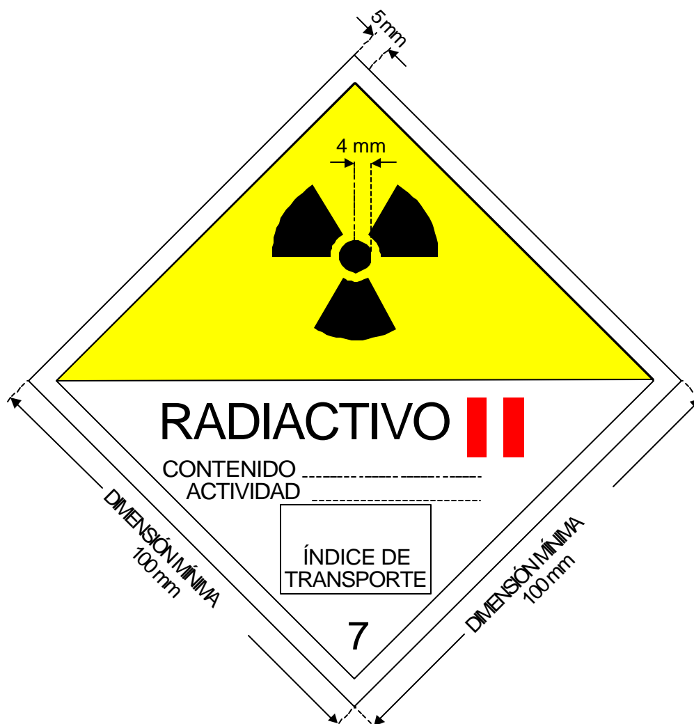
FIGURA 3. Etiqueta para la categoría II-AMARILLA. El color de fondo de la mitad superior de la etiqueta será amarillo y el de la mitad inferior blanco, el trébol y los caracteres y líneas impresos serán negros y las barras que indican la categoría serán rojas.
