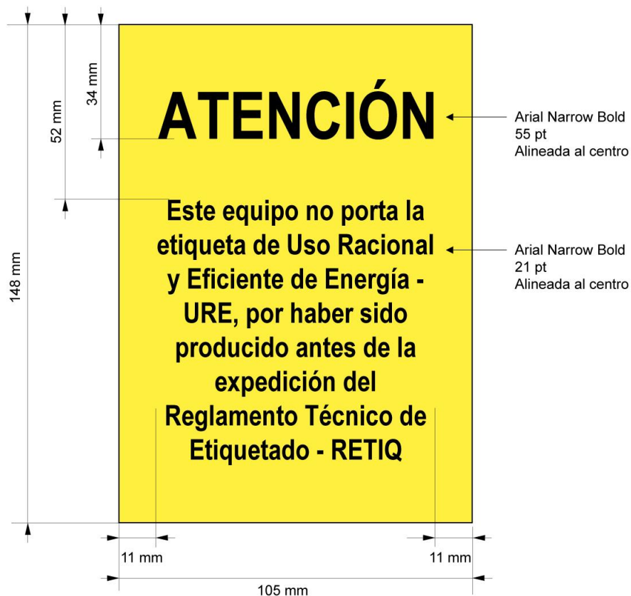
Figura 6.5.7 a. Dimensiones y tipo de letra del rótulo tamaño A6, para equipos excluidos de porte de etiqueta URE.
