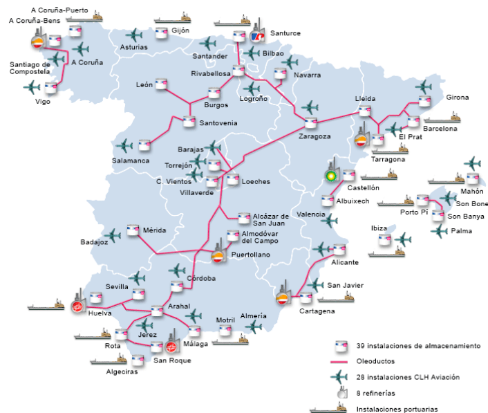
Figura 1. Red de refinación, transporte, almacenamiento y transporte de combustibles garantía de suministro de CLH en España.
